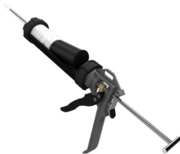
4. Die Kartusche senkrecht nach oben halten und pressen, bis das Mischrohr zu ca. drei Vierteln ausgefüllt ist. Anschließend alle Zwischenräume zwischen den Installationen mit der Schottmasse in einer Schottstärke von mind. 75 mm vollständig ausfüllen, so dass ein fester und dichter Anschluss an das Bauteil entsteht. An den Installationen ist abschließend beidseitig eine Wulst aus der Schottmasse vorzusehen (siehe Kapitel 6).
